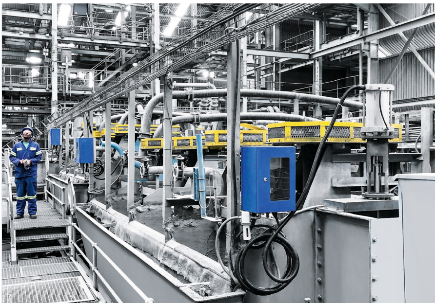
Bild: Flotationszellen in einer Mineralverarbeitungsanlage
